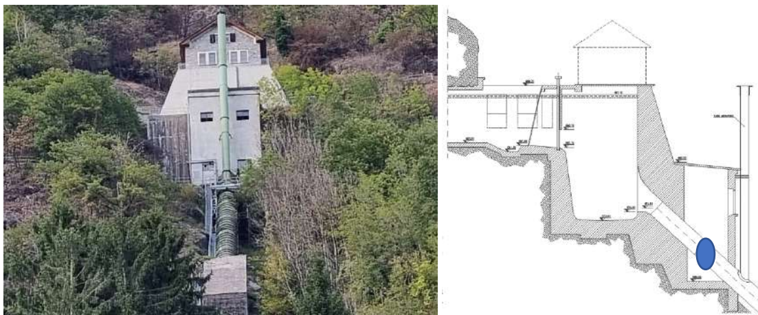
Figura 14 – Camera di carico. In blu evidenziata la posizione della valvola di testa condotta, all'interno della camera valvole
