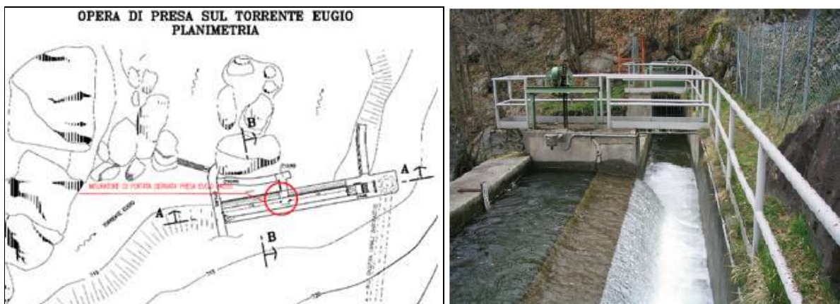
Figura 28 - Ubicazione del misuratore di portata derivata (a sx) e vista del canale derivatore con sensore di livello (a dx)
