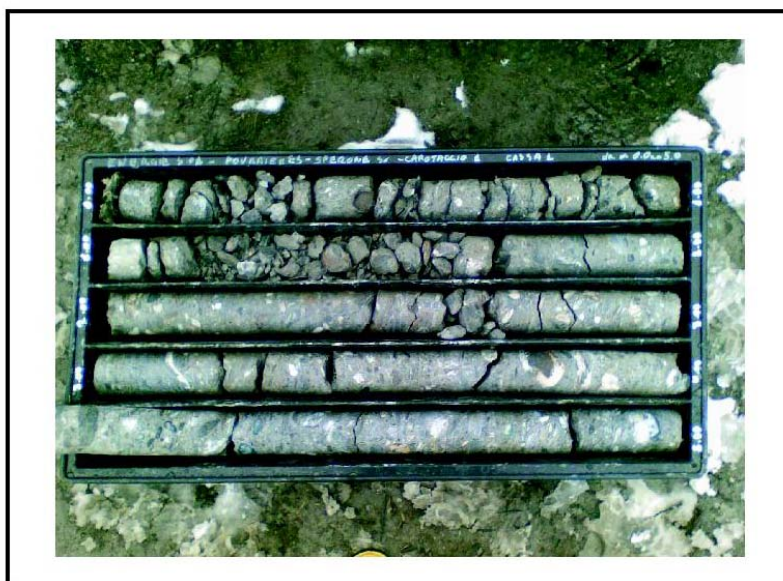
Foto 9: Carotaggio S1 (sbarramento – sperone sinistro) - cassa 1 - da 0.00 m a 5.00 m.
