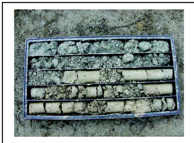
Foto 7: Sondaggio S1 (sbarramento – spalla sinistra) - cassa 3 - da 10.00 m a 15.00 m.
