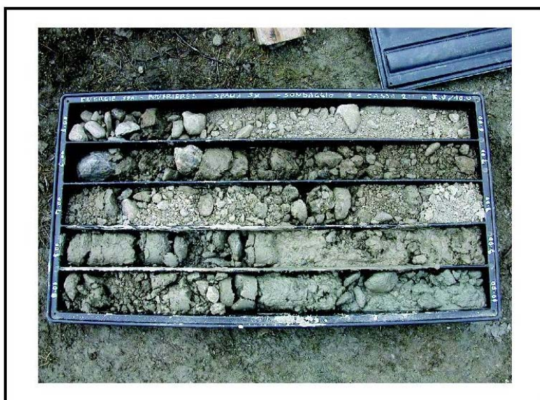
Foto 6: Sondaggio S1 (sbarramento – spalla sinistra) - cassa 2 - da 5.00 m a 10.00 m.
